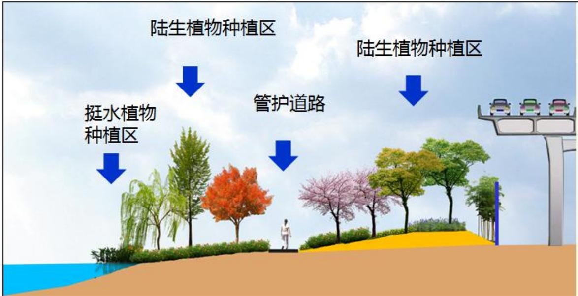
图 2.4-3 C 地块上设计植物种植断面图
